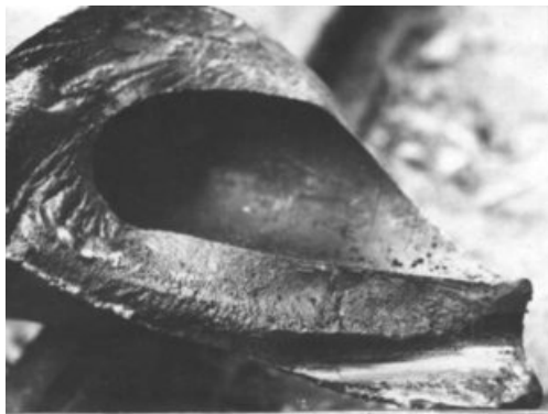
Рис. 1-5 Пример поломки гребного вала из-за крутильных колебаний
